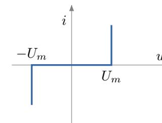
III.1. On observe que le courant dans le moteur devient non nul quand la force électromotrice  $E$  atteint la valeur de  $E_{\min} = 10\text{V}$ . En déduire la valeur de  $U_m$  puis, en admettant que  $U_m$  reste constant, l'expression de l'intensité du courant traversant le moteur quand  $E$  est supérieure à  $E_{\min}$ .
