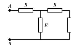
2. On considère la chaîne de résistors de la figure ci-dessous dans laquelle la « cellule » peut être répétée un grand nombre de fois.
