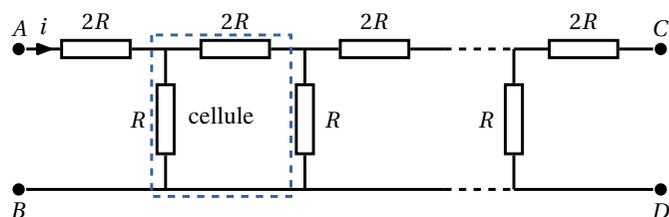
(a) On considère le cas à 0 cellules et on branche un résistor de résistance notée  $R_f$  entre les nœuds  $C$  et  $D$ . Calculer la résistance équivalente vue des nœuds  $A$  et  $B$ , notée  $R_e$  pour :
